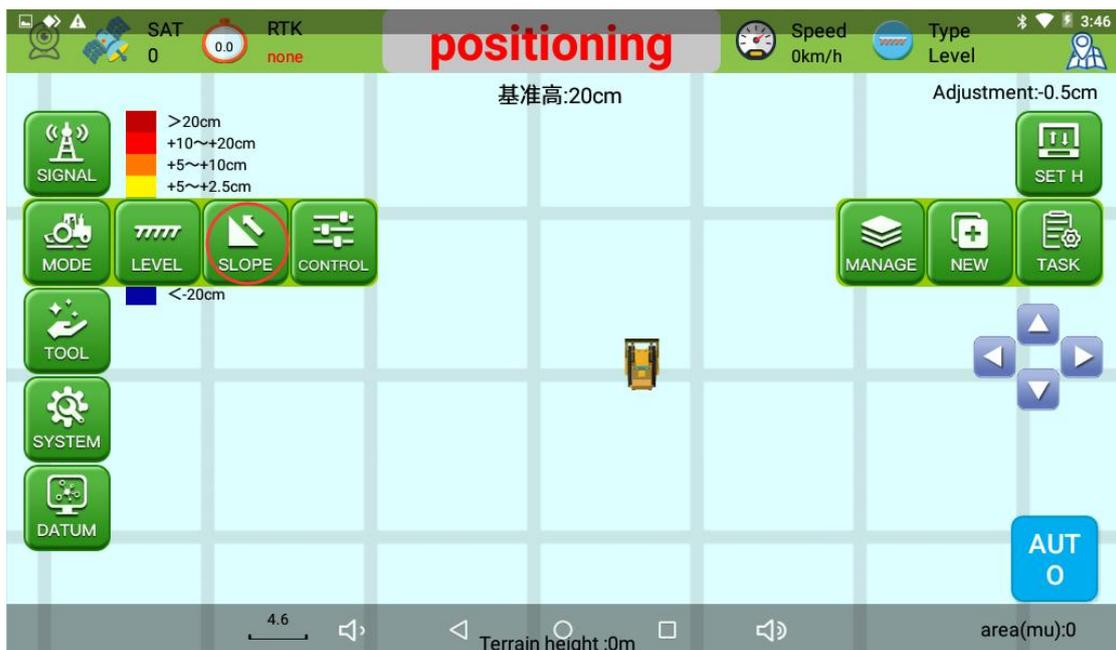
a. MODE -- SLOPE -- Two-point mode -- Collect point A -- Collect point B -- FINISH -- AUTO
